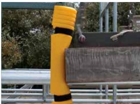
Le dispositif de protection monté sur palettiers a dépassé les exigences d'impact de la norme EN 15512.
