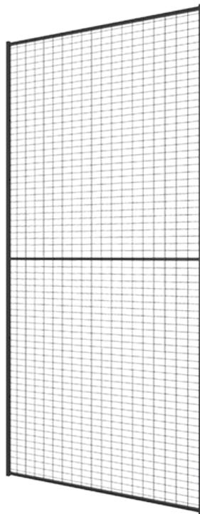
La taille de la maille est de 50x30 mm. La maille est constituée de fils verticaux de  $\varnothing$  3 mm et de fils horizontaux de  $\varnothing$  2,5 mm. La distance de sécurité recommandée est de 200 mm.
