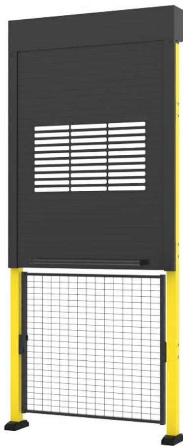
La porte enroulable se compose d'un système modulaire avec un support à ressort intégré et est disponible en standard en trois largeurs et deux hauteurs. X-Roll-up enroule la porte en aluminium pendant l'ouverture sur un support dans le caisson en haut.
